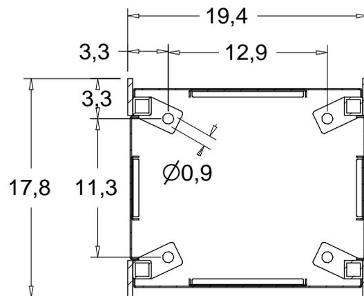
Sezione A-A (scala incrementata)
